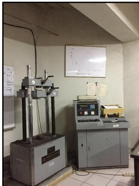
Gambar 1.3. Alat Uji Tarik Kapasitas 10 Ton Force
