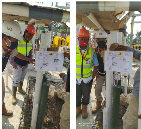
Gambar 4.2 Tes Tekan untuk Pipa Hydrant
