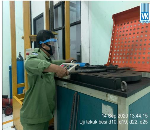
Gambar 4.5 Uji Tekuk untuk besi D10, D19, D22 & D25
