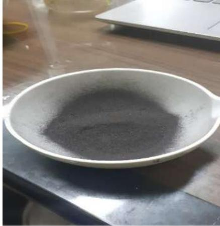
Gambar 5.17 Hasil *Sintering* material BaFe<sub>12</sub>O<sub>19</sub>
