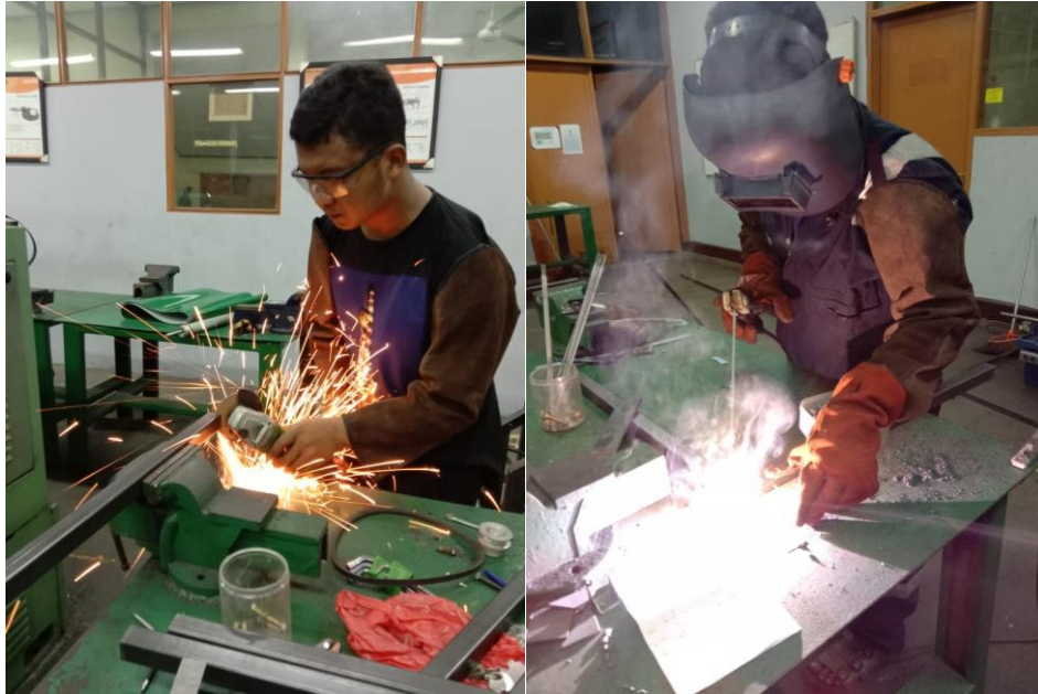
Gambar 3.3 Proses Pemotongan Pipa Galvanis
