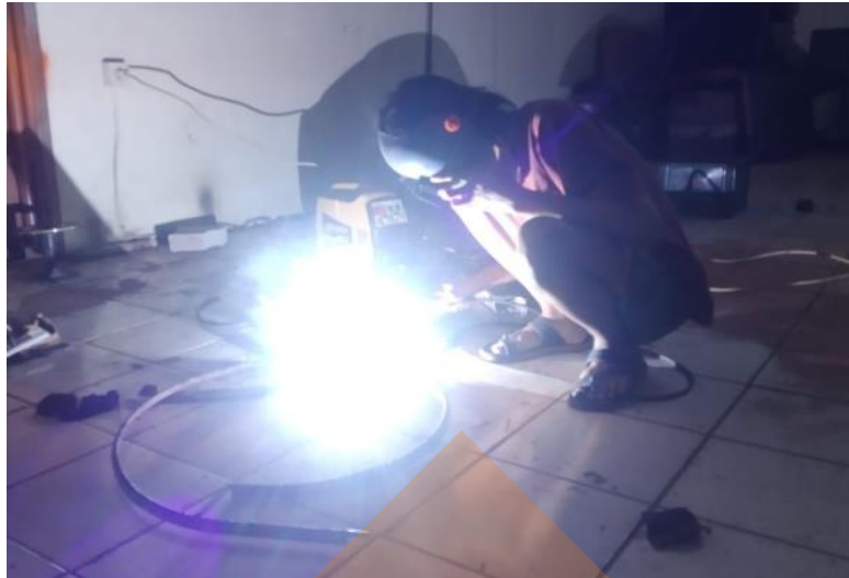
Gambar 3 Proses Pengelasan Penampang Turbin
