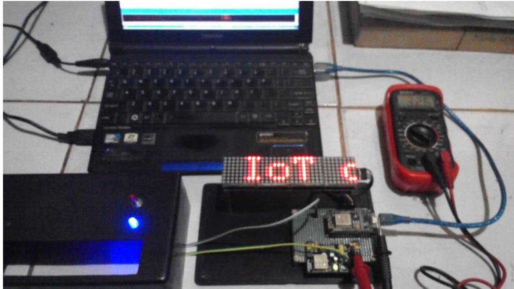
Gambar 4.1 Pengukuran tegangan pada modul display informasi lalu lintas
