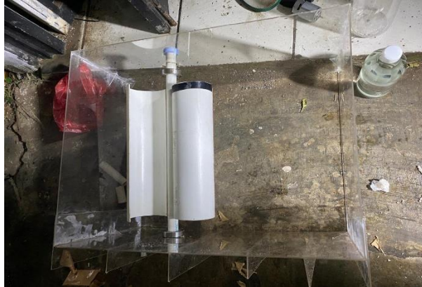
Gambar 3.10 Pemasangan turbin pada base akrilik
