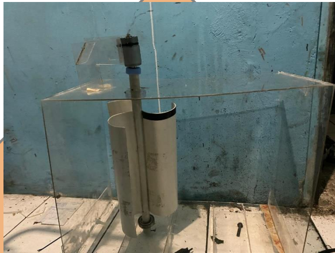
Gambar 3.11 Pemasangan generator pada poros turbin
