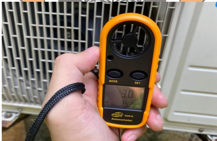
Gambar 3.12 Uji coba kecepatan aliran udara outdoor AC 0,5pk-2pk
