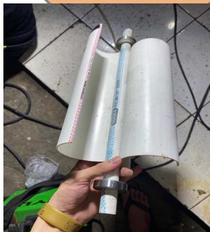
Gambar 3.9 Pemasangan bearing pada turbin angin tipe savonius
