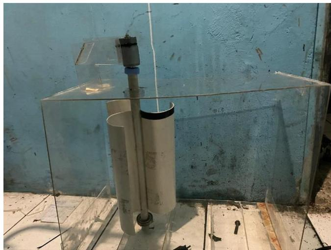
**Gambar 3.11** Pemasangan generator pada poros turbin
