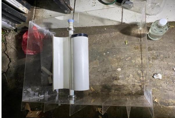
**Gambar 3.10** Pemasangan turbin pada base akrilik
