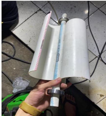
**Gambar 3.9** Pemasangan bearing pada turbin angin tipe savonius
