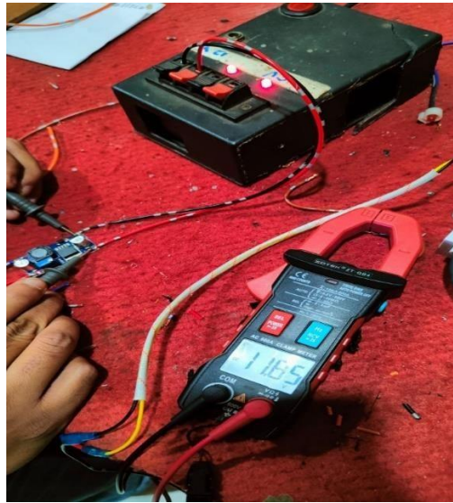
Gambar 4. 25 Hasil pengukuran tegangan output pada power supply
