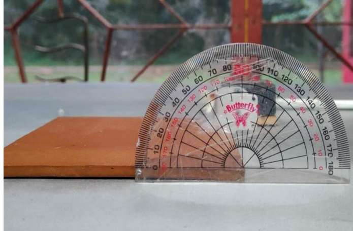
Gambar 4. 23 Hasil pengujian motor servo sudut 0^0
