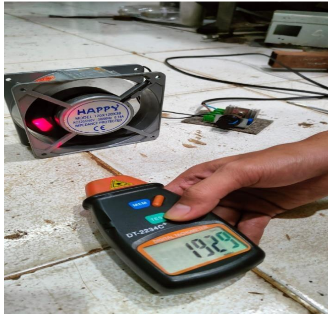
Gambar 4. 14 Pengujian kecepatan putaran baling-baling kipas
