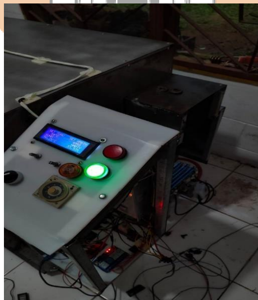
Gambar 4. 48 Burner menyala pada suhu <50^{\circ}\text{C}
