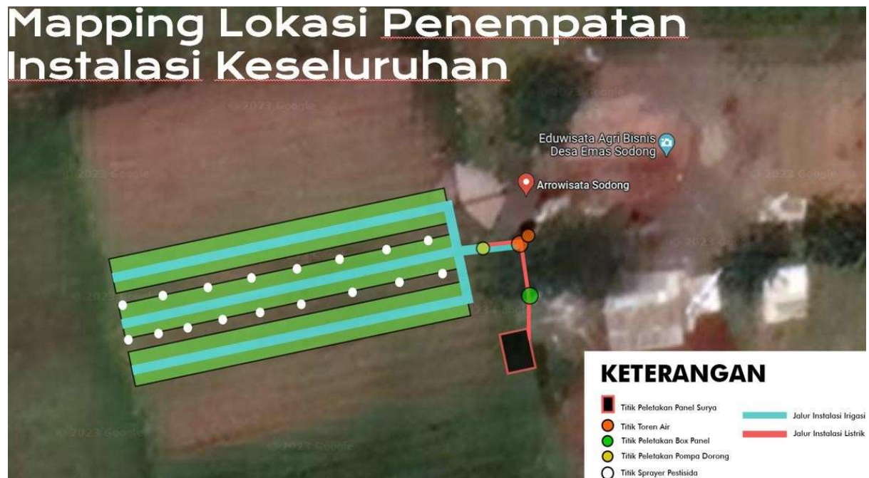
Gambar 14. Rancangan lokasi penempatan instalasi keseluruhan
