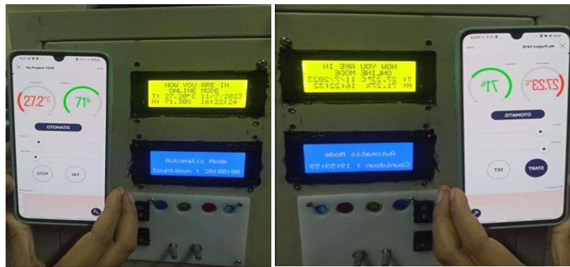
Gambar 4. 3 Hasil pengujian pembacaan suhu dan kelembapan pada serial display dan Blynk
