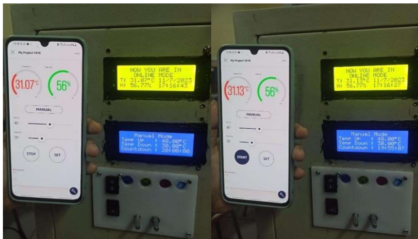
Gambar 4. 4 Hasil Pengujian pembacaan nilai suhu pada platform Blynk dan display
