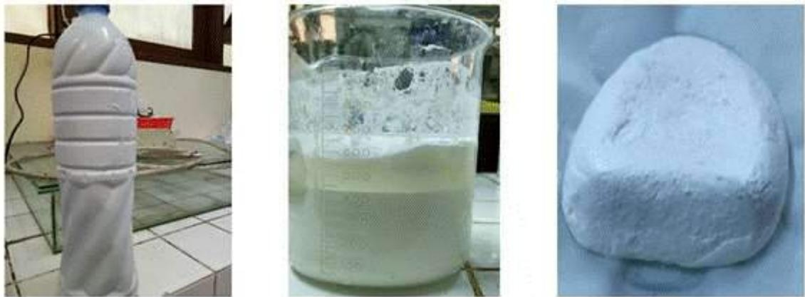
Gambar 30. Epoksidasi *Natural Rubber*
