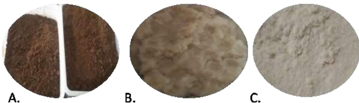
Gambar 10. A. Serat TKKS setelah delignifikasi, B. setelah bleaching dan C. Produk MFC
