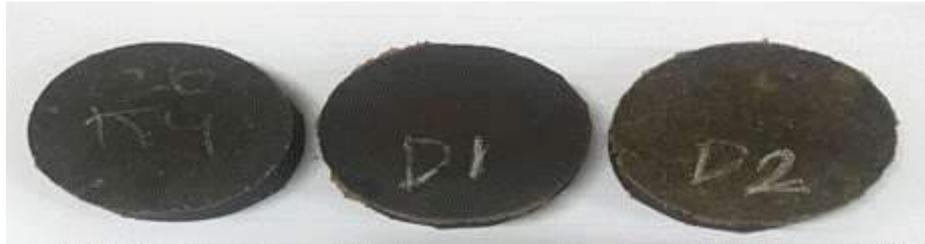
Gambar 50. Prototipe TPE Selulose/Latex/Aditif
