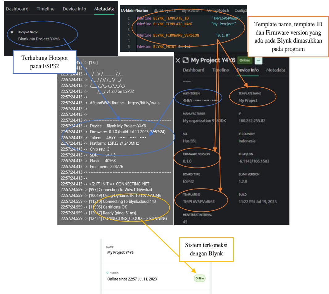
Gambar 4. 7 Pengujian koneksi sistem dengan Blynk
