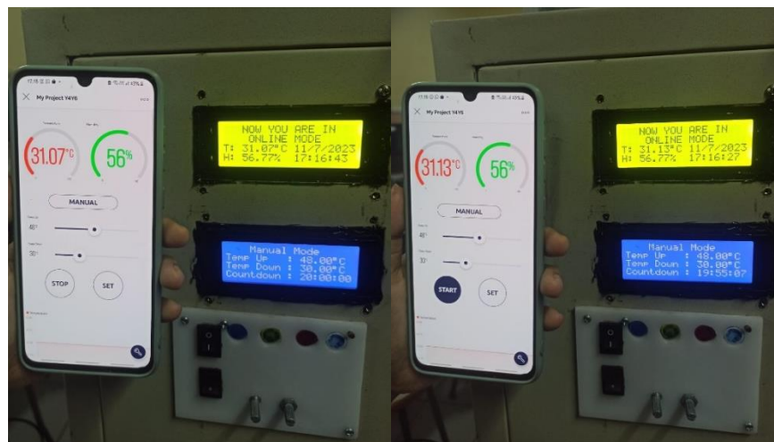
Gambar 4. 10 Hasil Pengujian pembacaan nilai suhu pada platform Blynk dan display
