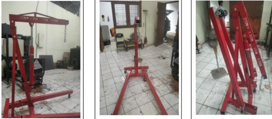
Gambar 5.5 portable crane untuk kendaraan roda dua yang telah selesai dibuat
