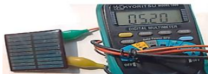
Gambar 3.6. Tegangan out put sel surya tanpa beban saat penyinaran sel surya
