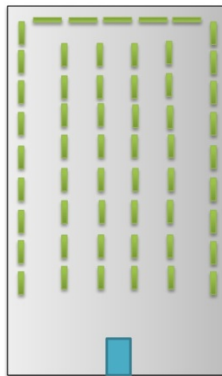
Gambar 4.4 Ruangan dalam cold storage dan tata letak rak
