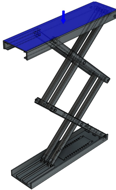
Gambar 4.37 Beban yang diberikan pada struktur
