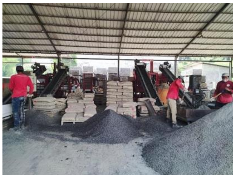
Gambar 7. Kegiatan Pekerja dalam Pencampuran Paving blok sesuai prosedur.
