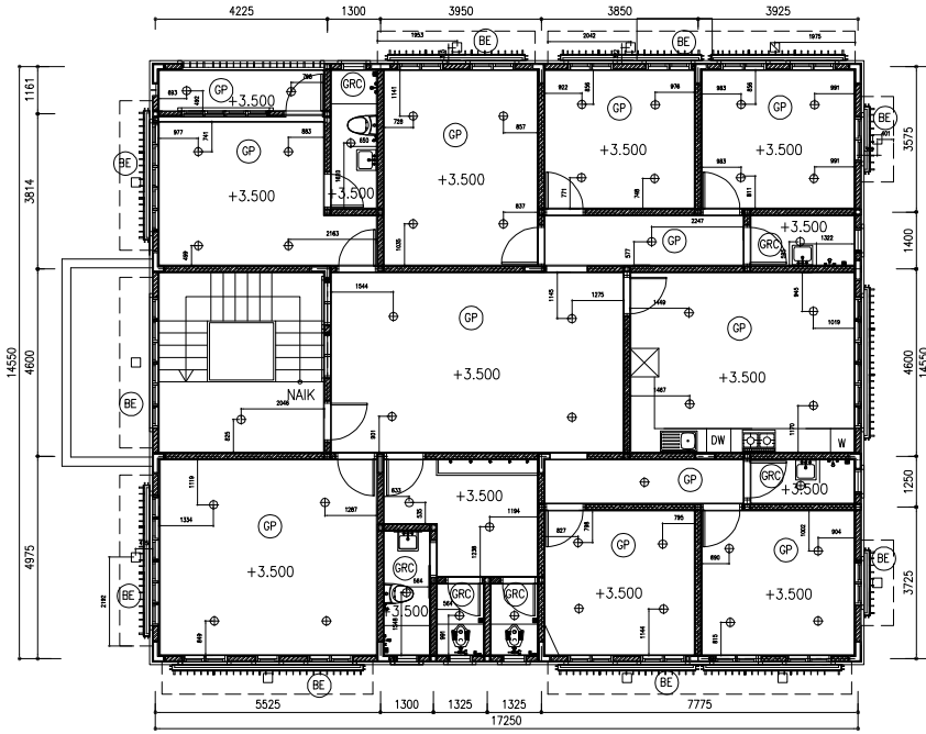
1 DENAH PLAFOND LANTAI 2 SKALA 1 : 100
