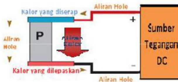
Gambar 2.5. Arah aliran hole pada semikonduktor tipe P (Tellurex, 2010)
