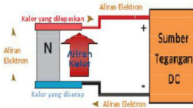
Gambar 2.4. Arah aliran elektron pada semikonduktor tipe N (Tellurex, 2010)
