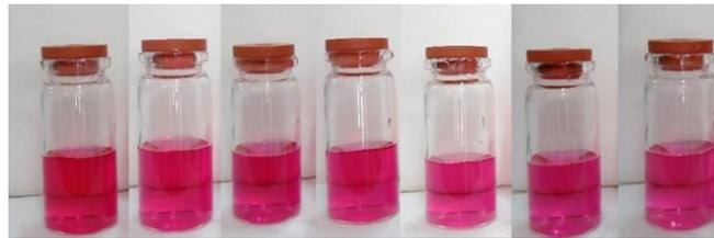
**Gambar 4. 29** Perubahan warna larutan zat warna *Base Red 218* 30 ppm.
