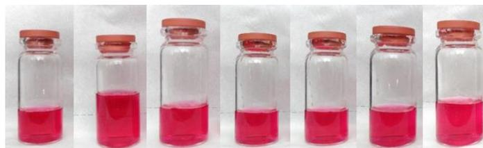
**Gambar 4. 30** Perubahan warna larutan zat warna *Base Red 218* 55 ppm.
