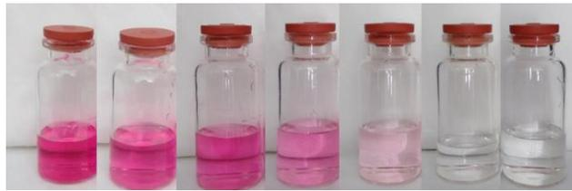
**Gambar 4. 28** Perubahan warna larutan zat warna *Base Red 218* 15 ppm.
