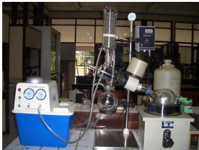
Gambar 12. Rangkaian alat sistem pemurnian produk rotary evaporator
