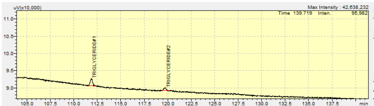
Gambar 16. Chromatogram GC produk biodiesel untuk trigliserida
