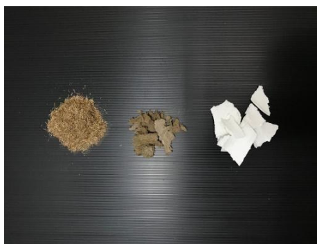
Gambar 5. TKKS (a) tanpa perlakuan, (b) alkalinasi, dan (c) bleaching
