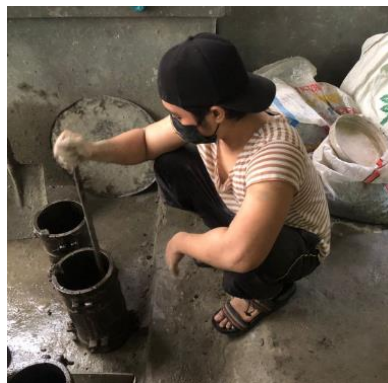
Foto 3.2 Memasukan adonan beton kedalam bekisting
