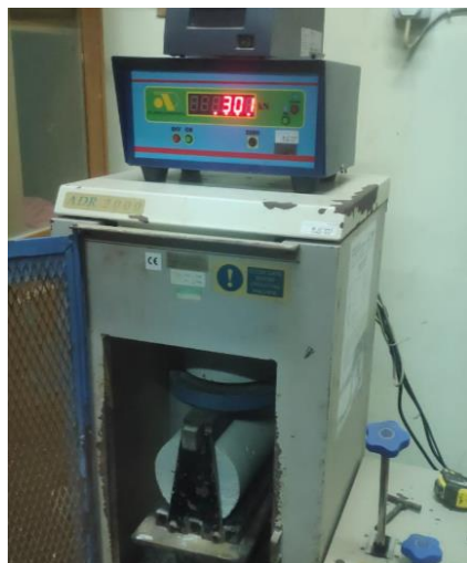
Foto 4.2 Proses Pengujian Kuat Tarik Belah
