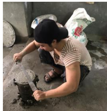
Foto 3.2 Memasukan adonan beton kedalam bekisting
