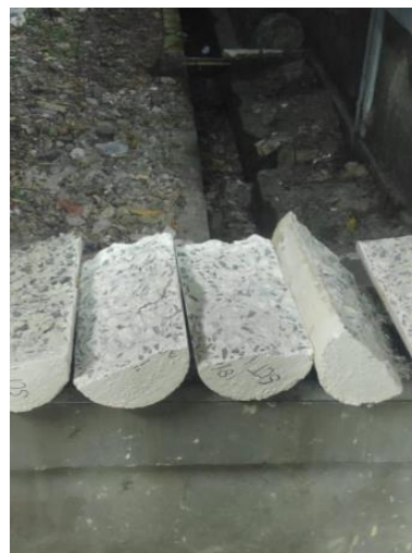
Foto 4.2 Proses Pengujian Kuat Tarik Belah
