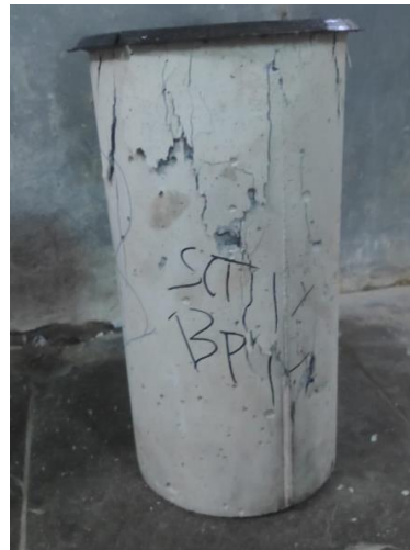
Foto 4.1 Proses Pengujian Kuat Tekan
