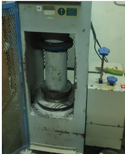
Foto 4.1 Proses Pengujian Kuat Tekan
