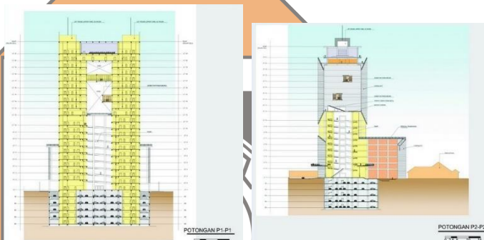
Gambar 2.42 Potongan Perpustakaan Nasional Republik Indonesia
