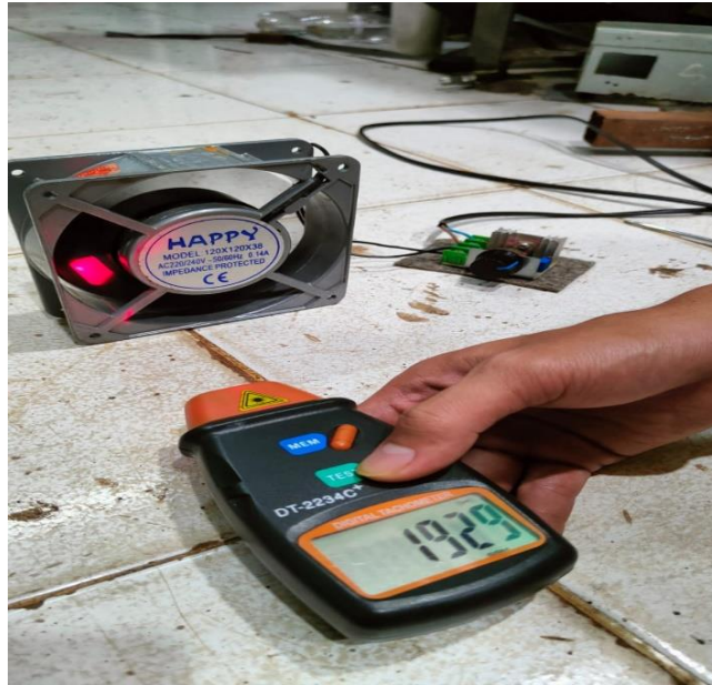
Gambar 4. 14 Pengujian kecepatan putaran baling-baling kipas
