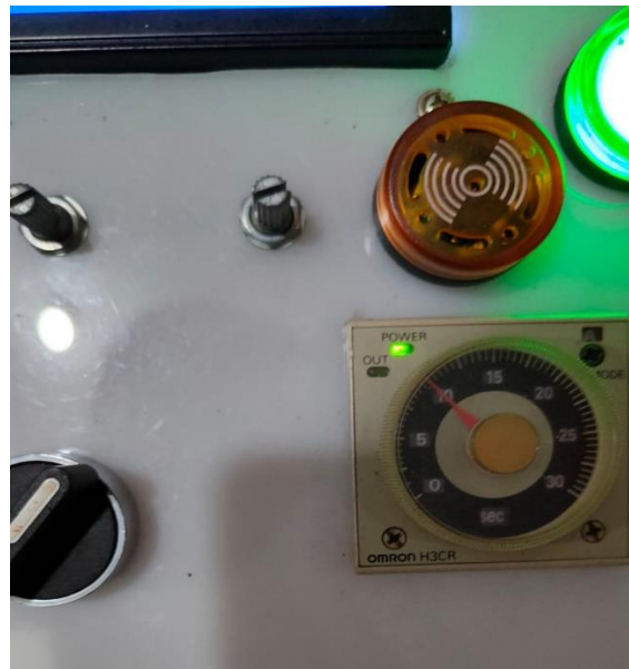
Gambar 4. 38 Pengujian pilot buzzer lamp saat waktu belum tercapai
