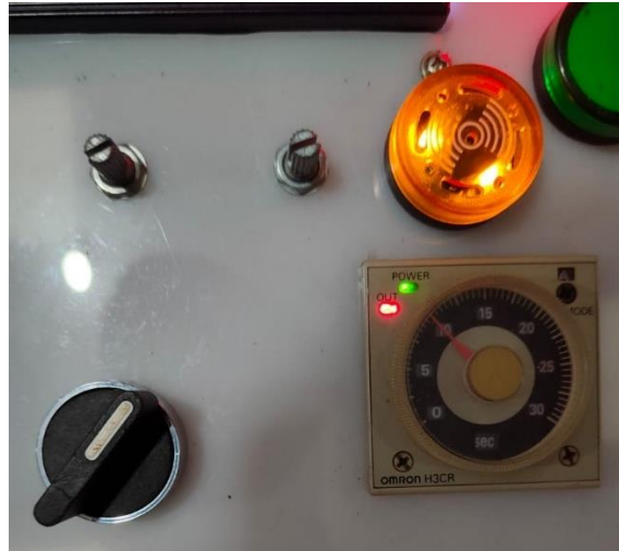
Gambar 4. 39 Hasil pengujian saat parameter waktu tercapai
