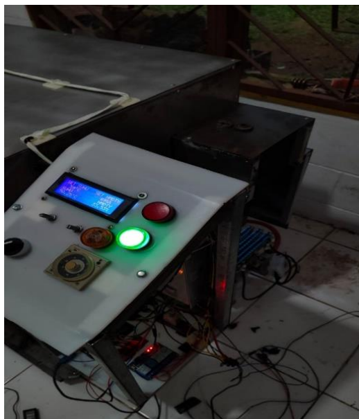
Gambar 4. 48 Burner menyala pada suhu <50^{\circ}\text{C}
