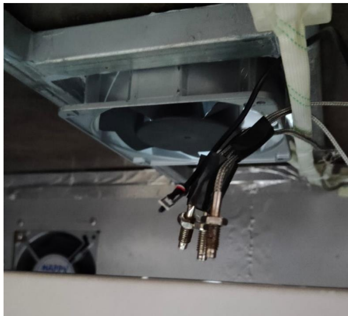
Gambar 4. 11 Pengujian sensor suhu dengan proses penurunan suhu ruangan
