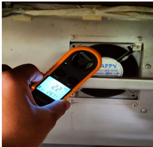
Gambar 4. 16 Pengujian kecepatan angin
