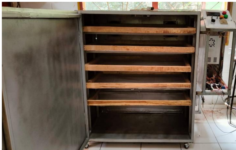
Gambar 3. 9 Bagian dalam alat pengering kerupuk
