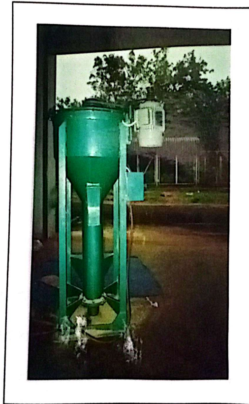
Gambar 6. Pandangan samping alat pencampur pakan ikan
