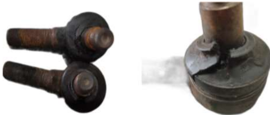
Gambar 3.1. Tie rod Truk DYNA 130 HT yang rusak
