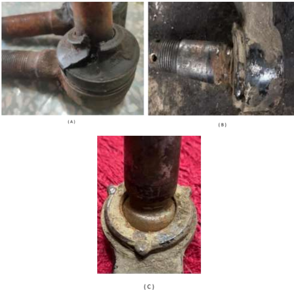
Gambar 4.1. Tie Rod Truk DYNA 130HT yang mengalami kerusakan.
