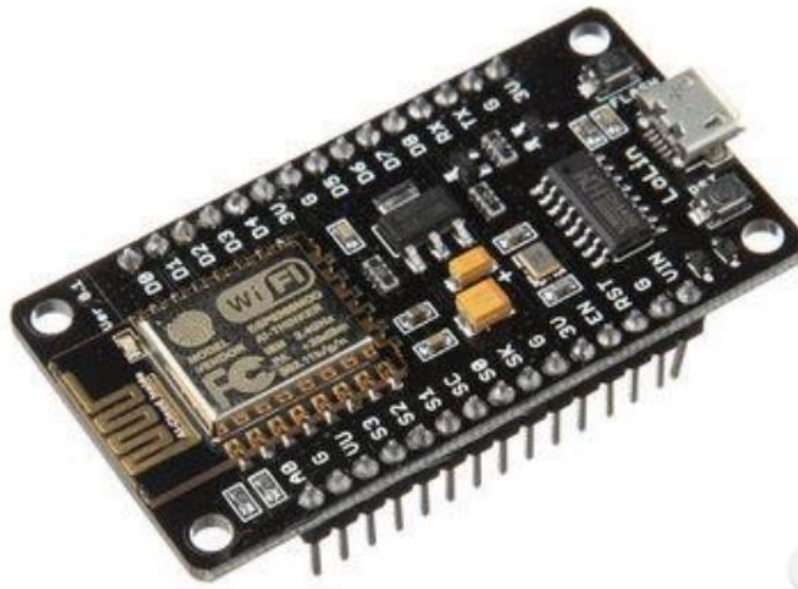
Gambar 2. 3. ESP8266 NodeMCU V3 [9]
