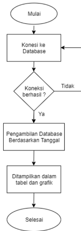
Gambar 3. 10. Flowchart penampilan rekap data berdasarkan waktu
