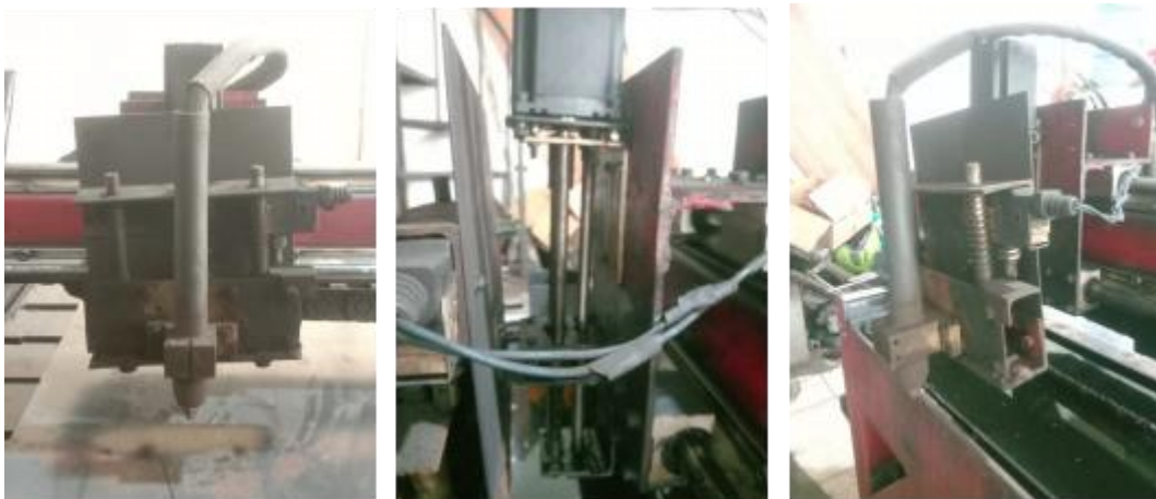
Gambar 7. Pemegang torch pada Sumbu Z CNC Plasma yang akan diperbaiki
