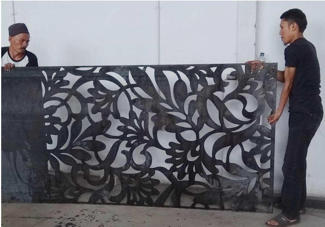
Gambar 2. Hasil Pemotongan CNC Plasma untuk Dekorasi
