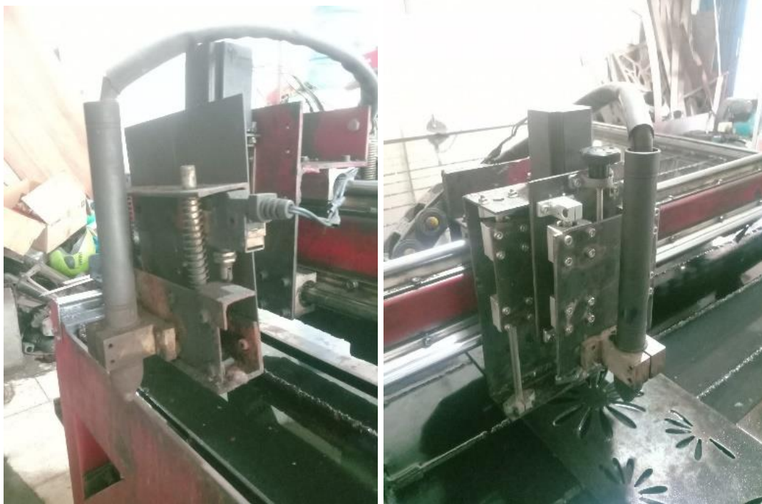
Gambar 16. Perbandingan pemegang torch sebelum (kiri) dan sesudah perbaikan (kanan). Terlihat pemegang torch yang baru lebih kokoh dibandingkan sebelumnya.
