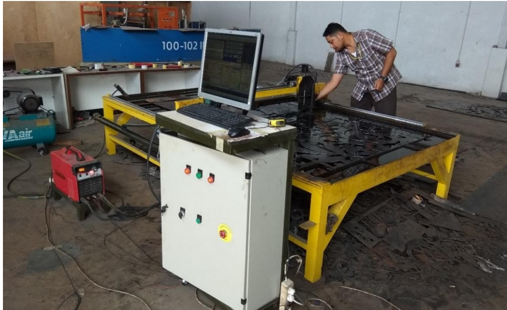
Gambar 3. Scrap hasil pemotongan di bawah mesin dapat melukai kaki operator
