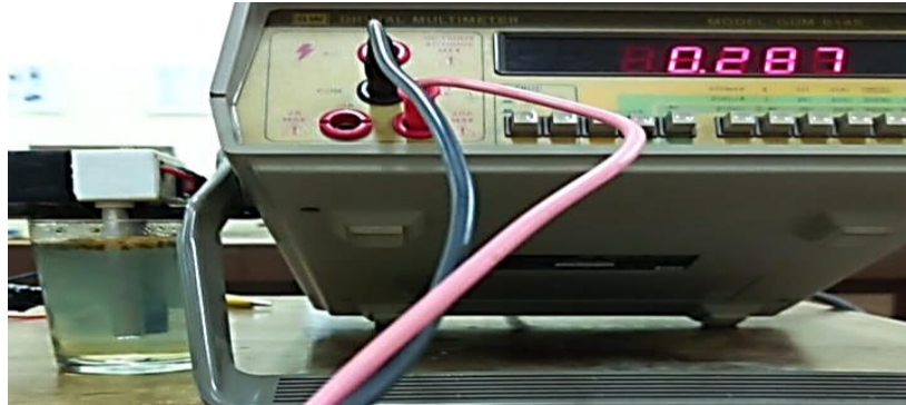
Gambar 3.6. Tampilan nilai I_{(air-tanah)} pada menit ke-dua
