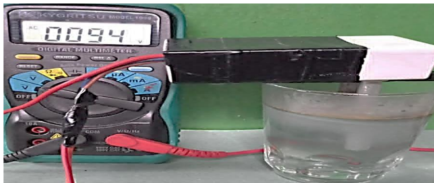
Gambar 3.4. Suplai sumber tegangan listrik ac output alat elektrolisa
