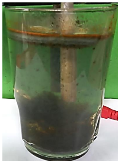
Gambar 3.7. Hasil akhir warna endapan dalam sampel air tanah
