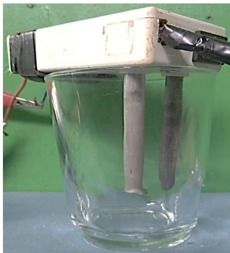
Gambar 3.1. Kedua elektroda alat elektrolisa air dalam wadah tanpa air
