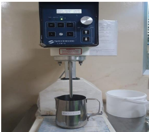
Mengaduk campuran fase I + Fase II + Fase III sampai homogen dengan Kecepatan 2400 rpm.
