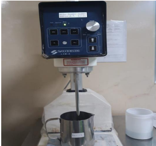
Mengaduk campuran fase I + fase II dengan kecepatan 3600 rpm selama 20 menit
