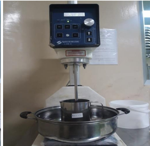
Mengaduk campuran fase I + fase II dengan kecepatan 3000 rpm sekaligus cooling sampai suhu 25°C
