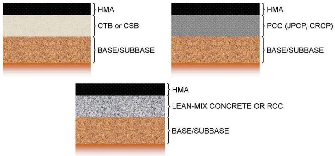
Gambar 2.1. Penampang Tipikal Perkerasan Komposit
