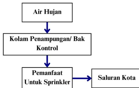
Gambar 5. 20 Sistem Pembuangan Air Hujan
