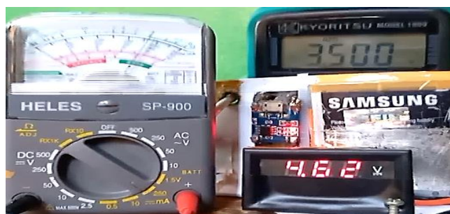
Gambar 3.5 Hasil V_{i(konv)} = 4,62 volt, V_{O(konv.)} = 3,50 volt dan I_{bat} = 0,178 \text{ A}
