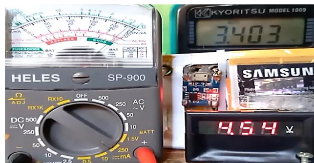
Gambar 3.4. Hasil pengukuran V_{i(konv)} , V_{O(konv.)} dan arus I_{bat}
