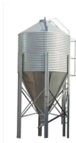
Gambar 4. 1 Silo Kalsium Oksida (S-02)
