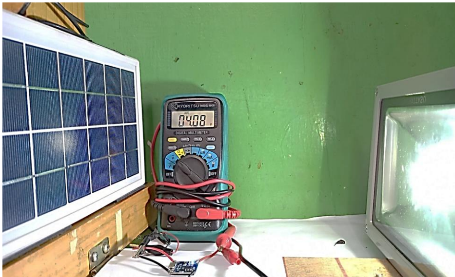
Gambar 3.7. Hasil V_{O(konv.)} = 4,08 volt pada kondisi V_{oc} = 5,15 volt
