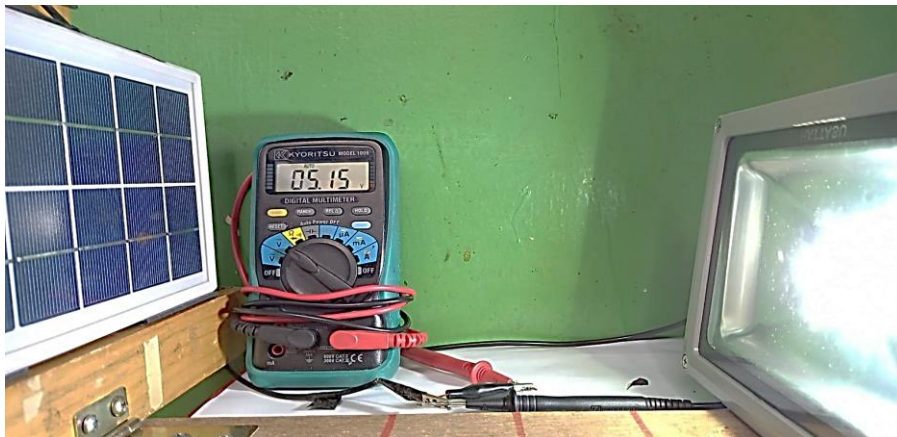
Gambar 3.4. Penyinaran cahaya lampu LED berjarak r = 0,25 meter
