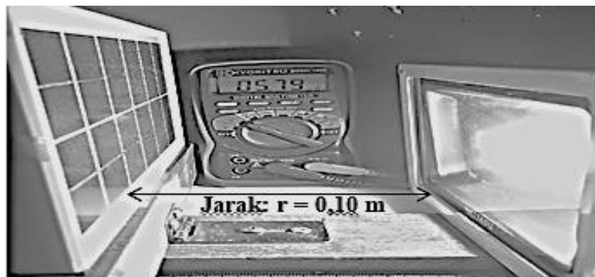
Gambar 3.3. Penyinaran cahaya lampu LED berjarak r = 0,10 \text{ meter}
