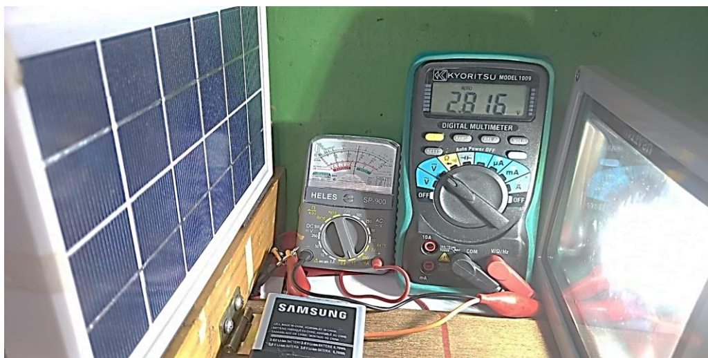
Gambar 3.8. Tegangan V_{oc} mengisi baterai charge sebesar V_{1(\text{bat.})} = 2,816 volt
