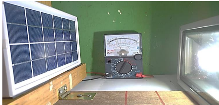
Gambar 3.6. Pengukuran arus listrik output I_{sc1} sel surya
