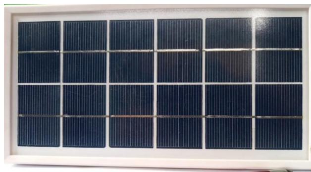
Gambar 2.1 Fisik panel sel surya tipe kapasitas 3 W (watt)
