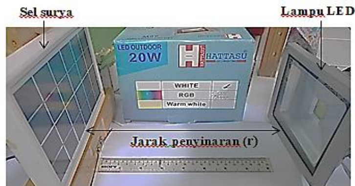
Gambar 3.1. Penyinaran permukaan sel surya dengan cahaya lampu LED
