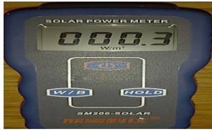
Gambar 3.5. Fisik alat ukur intensitas cahaya satuan watt/m 2
