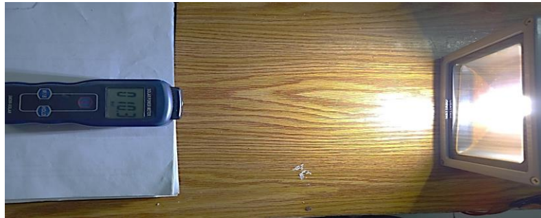
Gambar 3.6. Pengukuran intensitas cahaya parameter I_{\text{cahaya(W)}}
