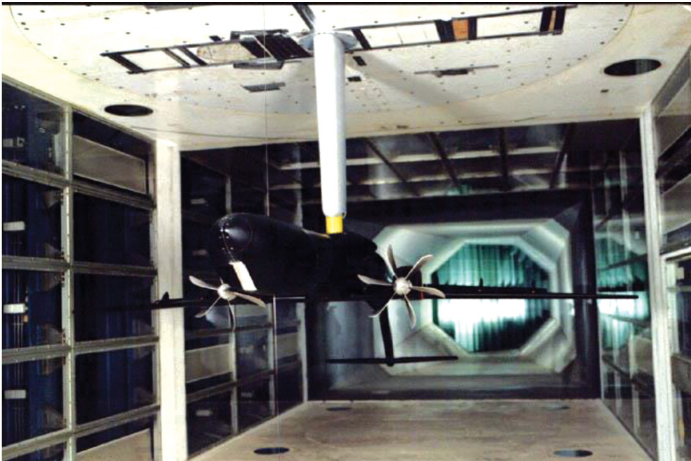
Gambar 4. Pengujian Simulasi Model Propeler pada Pesawat N-250, 1992.
