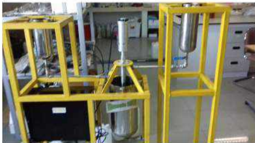
Gambar 2.3 Pilot plant proses produksi biodiesel secara kontinu (Widayat dkk, 2017)
